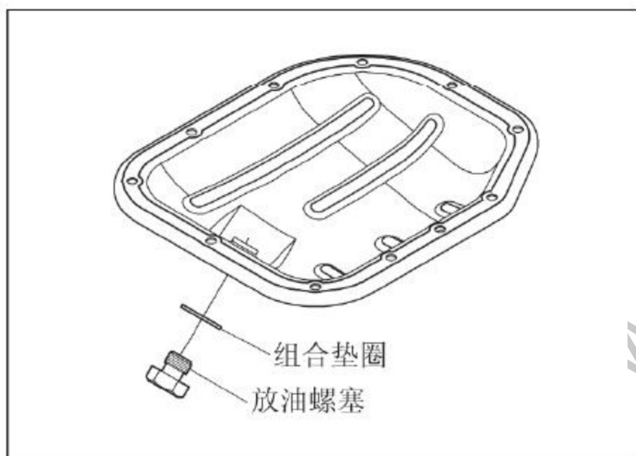
图10-2-5 拆装油底壳放油螺塞
